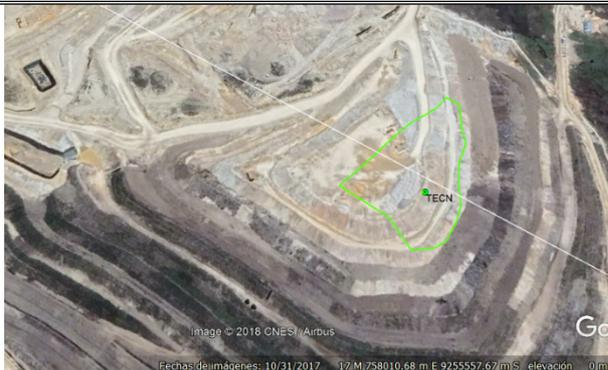
Ubicación de la plataforma para la producción de suelos mejorados en sobre el Depósito de Material Estéril de Tantahuatay.
