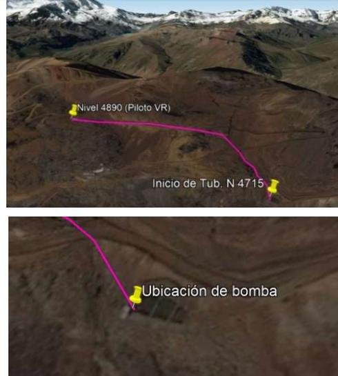
Foto 4: Vista de la zona donde se ubica el inicio de la bomba y el inicio de la tubería del nivel 4715 hasta el nivel 4890.
