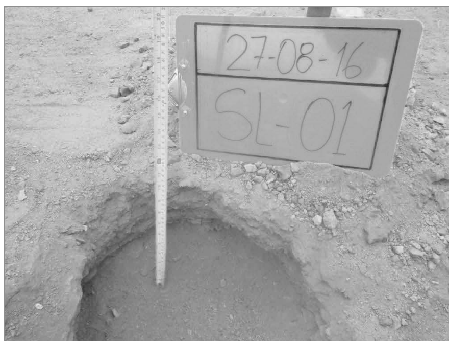
Imagen 02: Perfil modal del suelo Casa Blanca con secuencia de horizontes Cr – R
