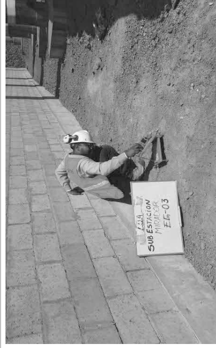
Foto 09. Vista del ensayo de TILT TEST EG- 03
