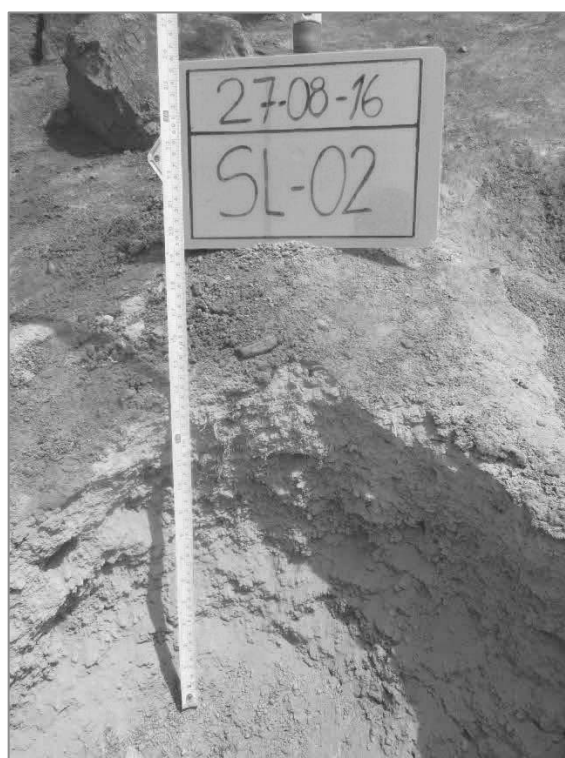
Imagen 04: Perfil modal del suelo Rosal con secuencia de horizontes C – Cr – R
