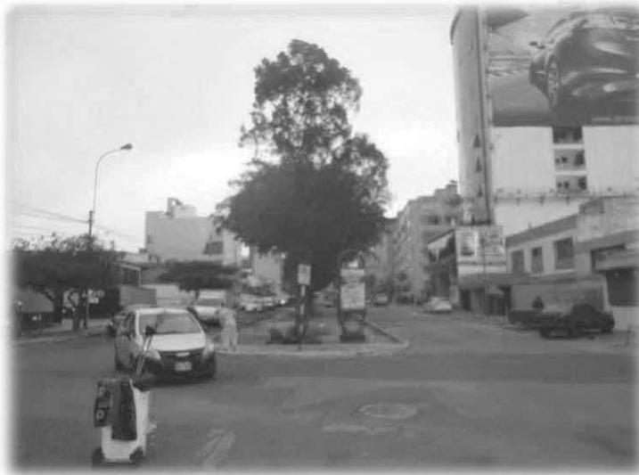
**Tramo 2 Av. República de Panamá – Av. Del Parque Sur,** Conformada por dos pistas de dos carriles por sentido de tráfico separados por una berma central de sección variable a lo largo de sus 450 metros. Las secciones de las pistas existentes varían entre 6.03 y 7.44 metros Cuenta con 02 intersecciones semaforizadas.
