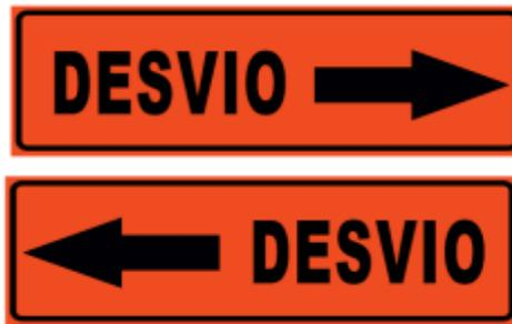
Todas las señales anteriores serán colocadas al lado derecho de la vía, teniendo en cuenta el sentido de circulación y de forma que el plano frontal de la señal y el eje de la vía formen un ángulo comprendido entre 85° y 90° para que su visibilidad sea óptima. Cuando la visibilidad del lado derecho no sea completa, debe colocarse una señal adicional en el lado izquierdo de la vía.
