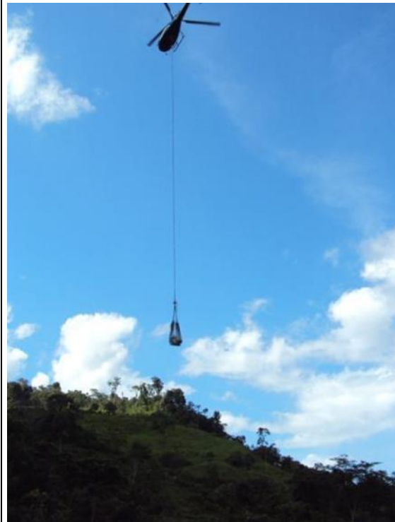
Fotografía ¡Error! No hay texto con el estilo especificado en el documento.-3 Helicóptero preparando el enganche de la carga y transporte agregado
