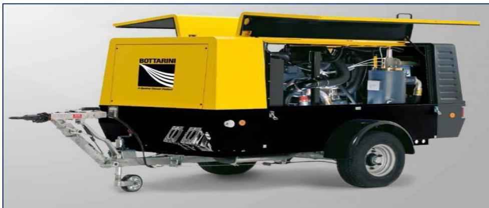
Fotografía N° 08.- Vista fotografica del equipo (compresora) ha de utilizar en,El trabajo de corte en roca suelta y dura.
